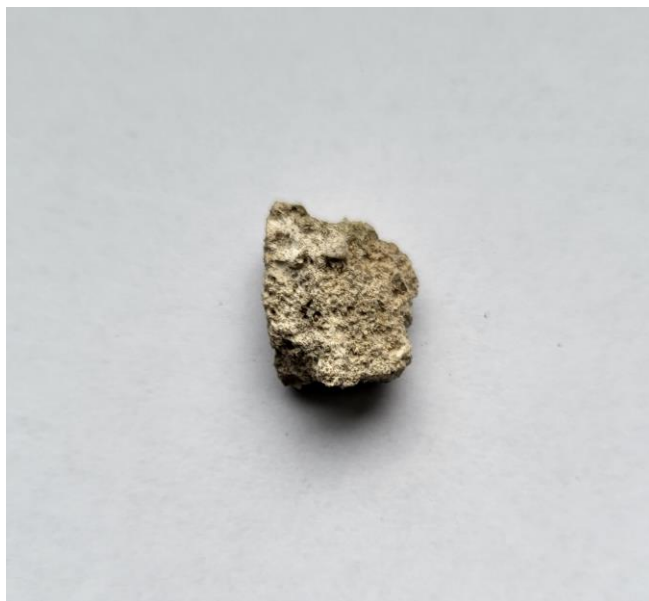
Próbka nr 4. spoina, uzupełnienie od wewnątrz.
